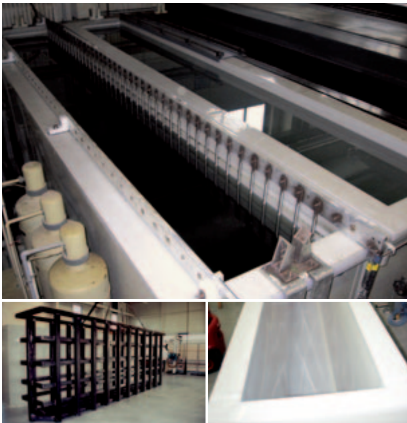
Der Blick auf die Galvanikwannen lässt das System der „Lose-Hemd-Auskleidung“, außen SIMONA® PP-DWU, innen SIMONA® PVDF, erkennen. Unten links: Ansicht der Kreuzverrippung aus Stahl.
